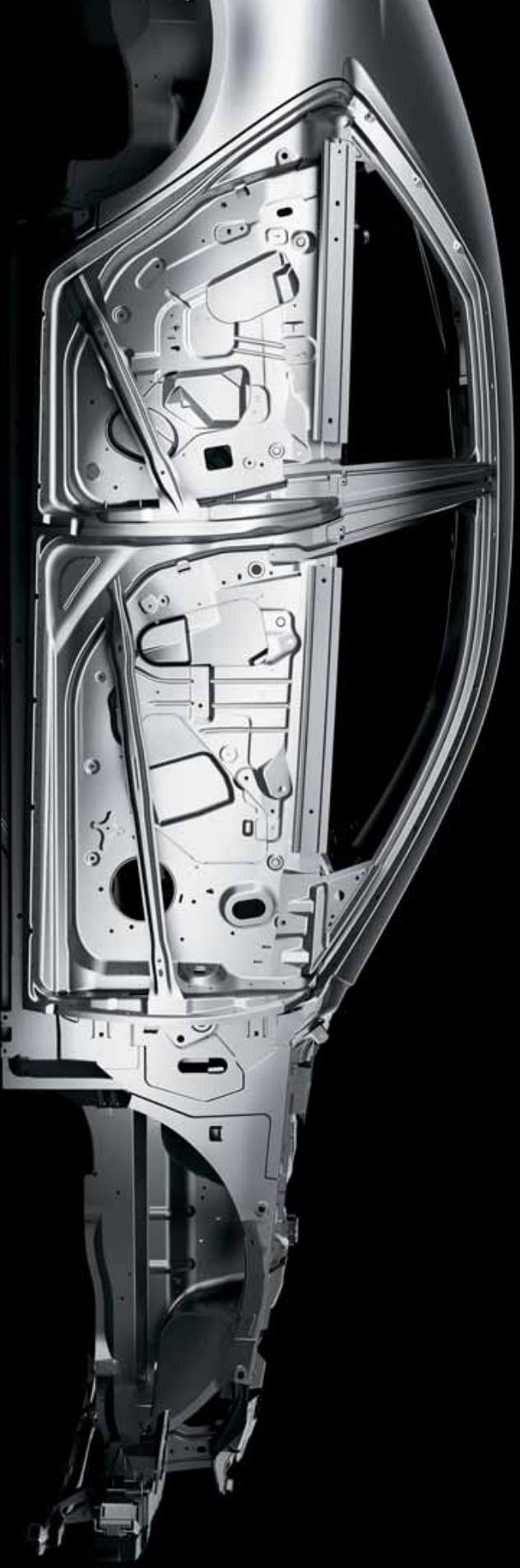
THE CTS SURROUNDS ITS OCCUPANTS WITH A STRONG BUT LIGHTWEIGHT BODY STRUCTURE, DOORS THAT ARE BRACED WITH ULTRA-STRONG STEEL BEAMS AND FRONT AND REAR CRUMPLE ZONES.
